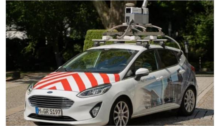
Fahrzeug der Firma Cyclomedia mit 360-Grad-Kamera und Messtechnik © Cyclomedia
